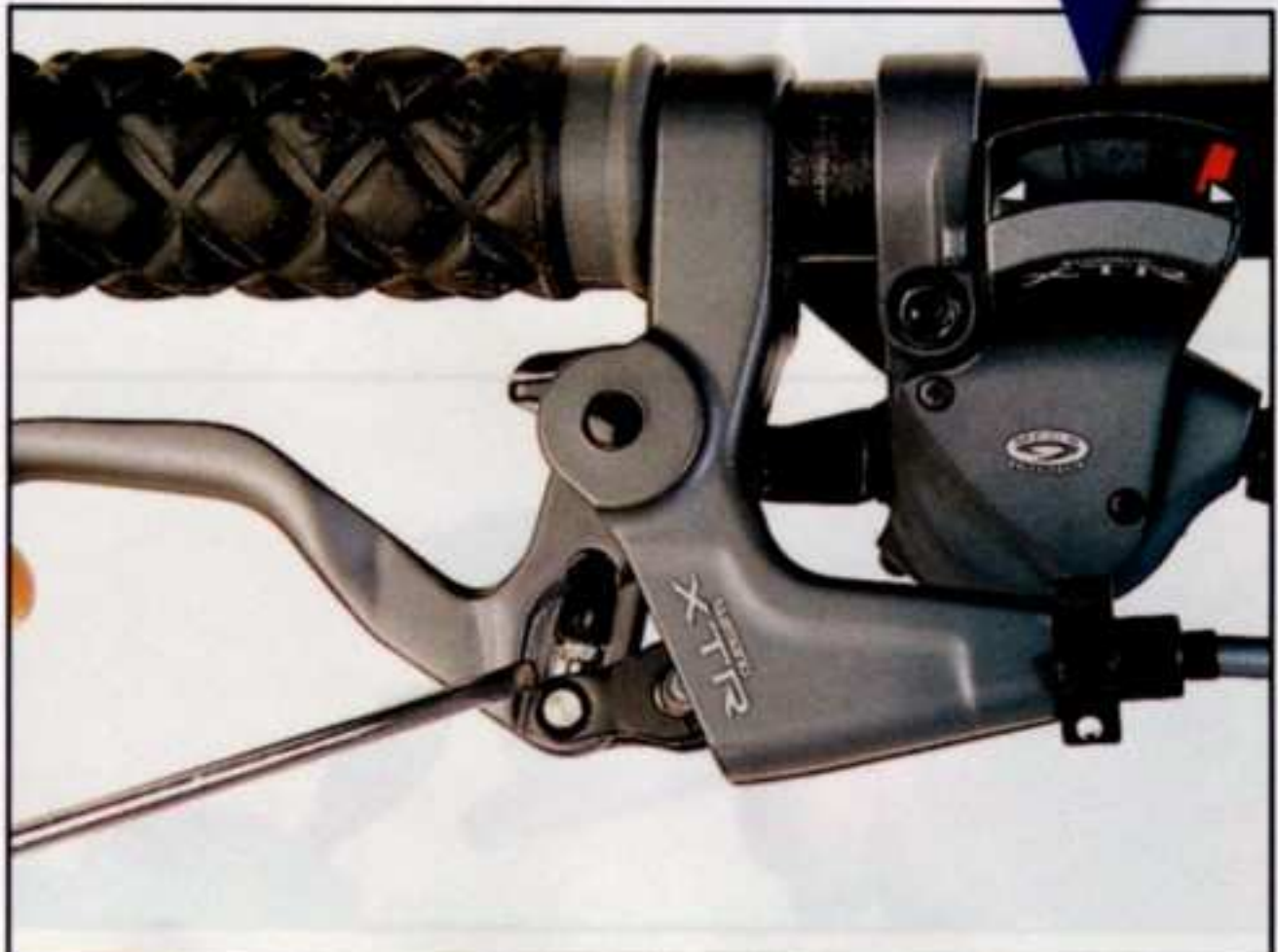
8 Chez Shimano, on rencontre plusieurs systèmes : une vis/axe supérieur à trois positions sur les leviers LX, une molette dans le corps du levier sur le XTR (photo), des rondelles demi-lunes dans le corps des leviers XT. Chez Sram, il s'agit de cames amovibles.
