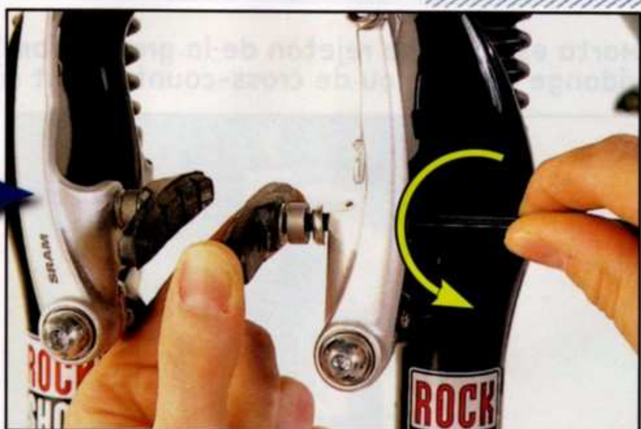
5 Démontez les tiges supports et inversez la position des rondelles pour rapprocher (rondelle fine à l'intérieur) ou éloigner (rondelle épaisse à l'intérieur) le patin de son support. Veillez à bien positionner la rondelle bombée et à effectuer un réglage symétrique.
