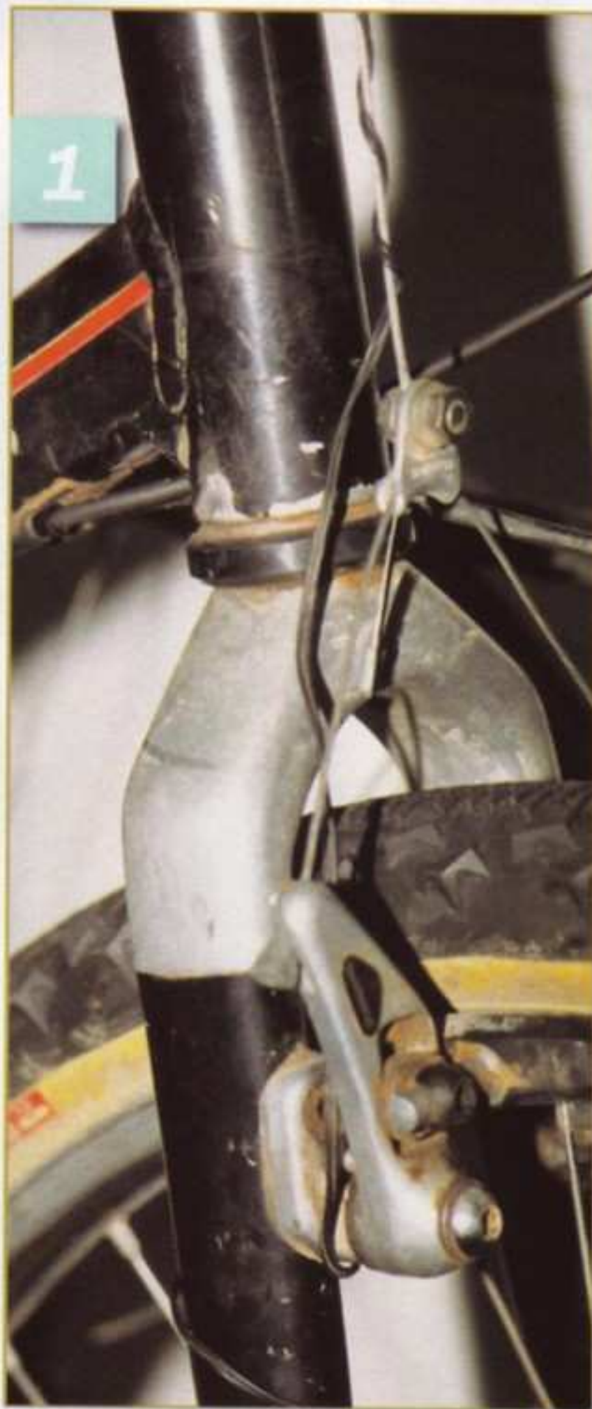
1 - Une peinture fendue au niveau du jeu de direction révèle souvent une ovalisation de la douille de direction. Pas bon.
